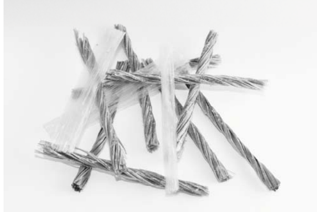
Kuva 5. Esimerkki valmiista mikro – ja makropolymeerikuidun sekoituksesta.
