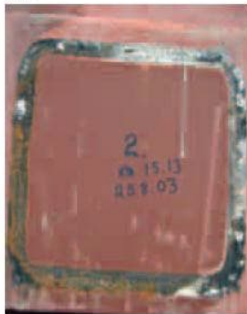
Kuva vahvistuslevystä, josta konsoli on repeytynyt irti. Pienahitsin laatu oli huono.
