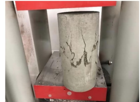
Kuva 3. Tyypillinen standardilieriön murtuminen puristuskokeessa.
