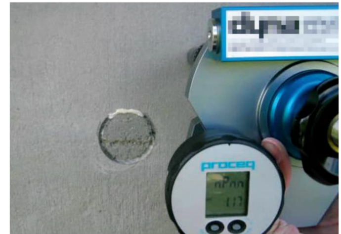
Kuva 14. Pinnoitteen tartunnan tarkastaminen vetokokeella.
