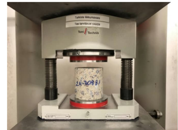
Kuva 31. Testauskoneen 1 kuormituskehikko halkaisijaltaan D50-D100 koekappaleille. Kuvassa kuormituskehikkoon on keskitetty D80x80 rakennekoekappale.
