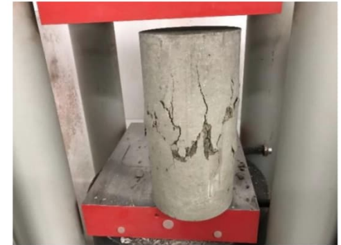
Kuva 3. Tyypillinen standardilieriön murtuminen puristuskokeessa.
