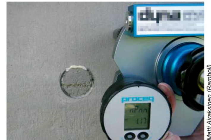
Kuva 14. Pinnoitteen tartunnan tarkastaminen veto- kokeella.
