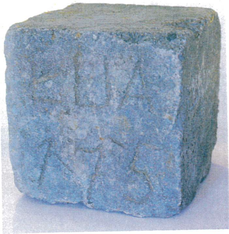
8. Luumäeltä 1994 löytynyt Salpalinjaan kuuluva koekappale (20 cm:n kuutio) on unohnutun metsään 1940 tai 41. Koekappale, kolhuista huolimatta, on edelleen hyvässä kunnossa ilman merkkejä rapautumisesta, vaikka se on maannut Luumäen sammalissa yli 50 vuotta.
