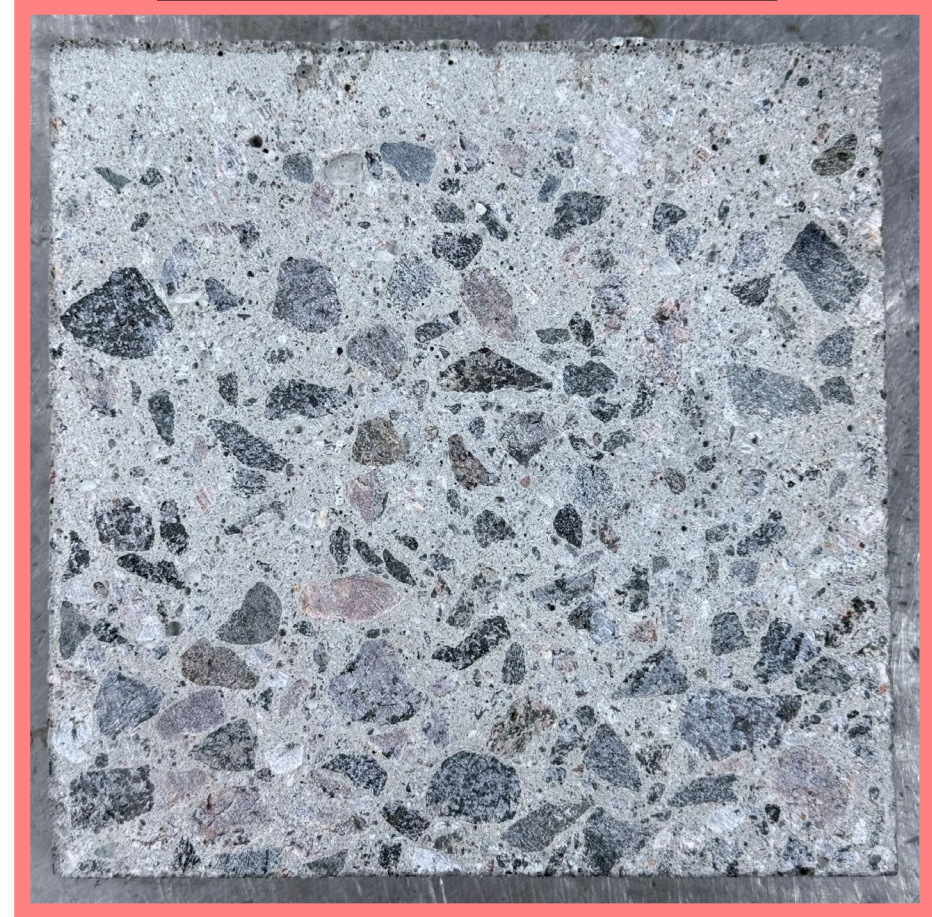
Huonosti tiivistetty koekappale
